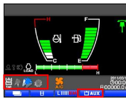
Tramite il computer di bordo è possibile aumentare o diminuire la quantità di olio al sistema ausiliario.
